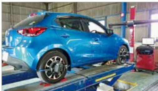
▲ホイール・アライメント・テスターによる診断 ▲塗装コンピュータによる調色
