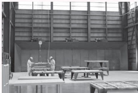
塗装ブースと大型排気装置
